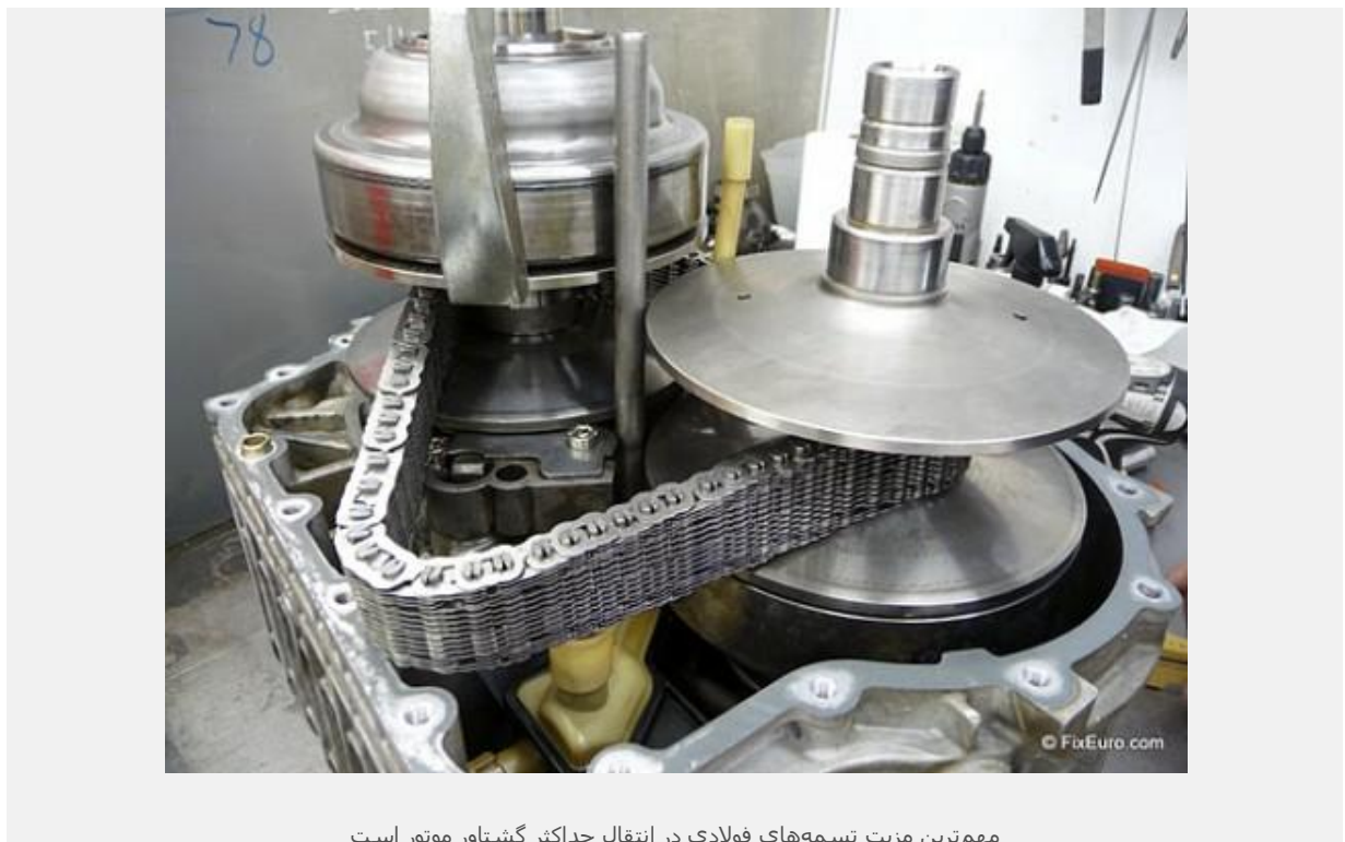
مهمترین مزیت تسمه های فولادی در انتقال حداکثر گشتاور موتور است
