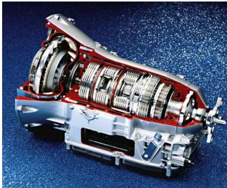
نمونه برش خورده یک گیرکس اتوماتیک (Mercedes-Benz CLK)
