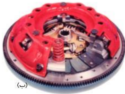
شکل 1-4 (الف) اجزا یک کلاچ تک صفحه ای (ب) نمونه یک کلاچ تک صفحه ای با فتر فشاری
