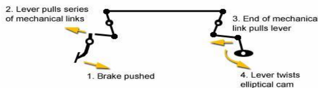
شکل ۴-۱۱ میله بندی مکانیکی عملگر ترمز
